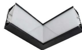
UNION INTERNA EN L 14W Aluminio / Difusor Plástico 100Lm x W 150x150mm 4000K 100-265v Ref.:RW-BR6075-14W
