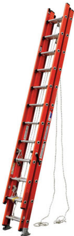
Escalera Telescópica / Fibra de Vidrio Peso Máx de Carga: 300 Libras 7.32mts / 24Pies Cod.: 320515 8.55mts / 28Pies Cod.: 320516 9.75mts / 32Pies Cod.: 320517
